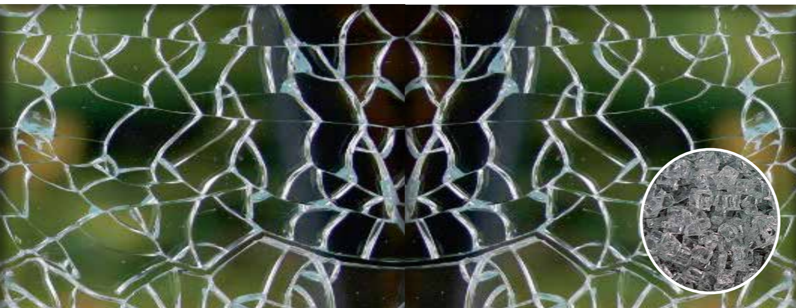
Splitterbild ESG Zerfall in unscharfkantige Kleinsplinter
