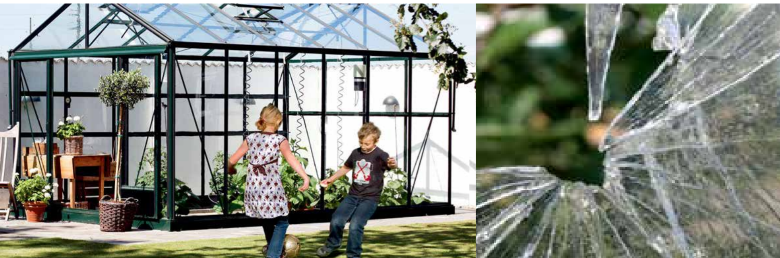
Splitterbild Glas scharfkantiger Bruch hohes Verletzungsrisiko
