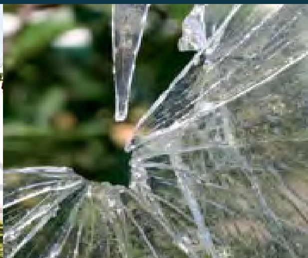
Splitterbild Glas scharfkantiger Bruch hohes Verletzungsrisiko
