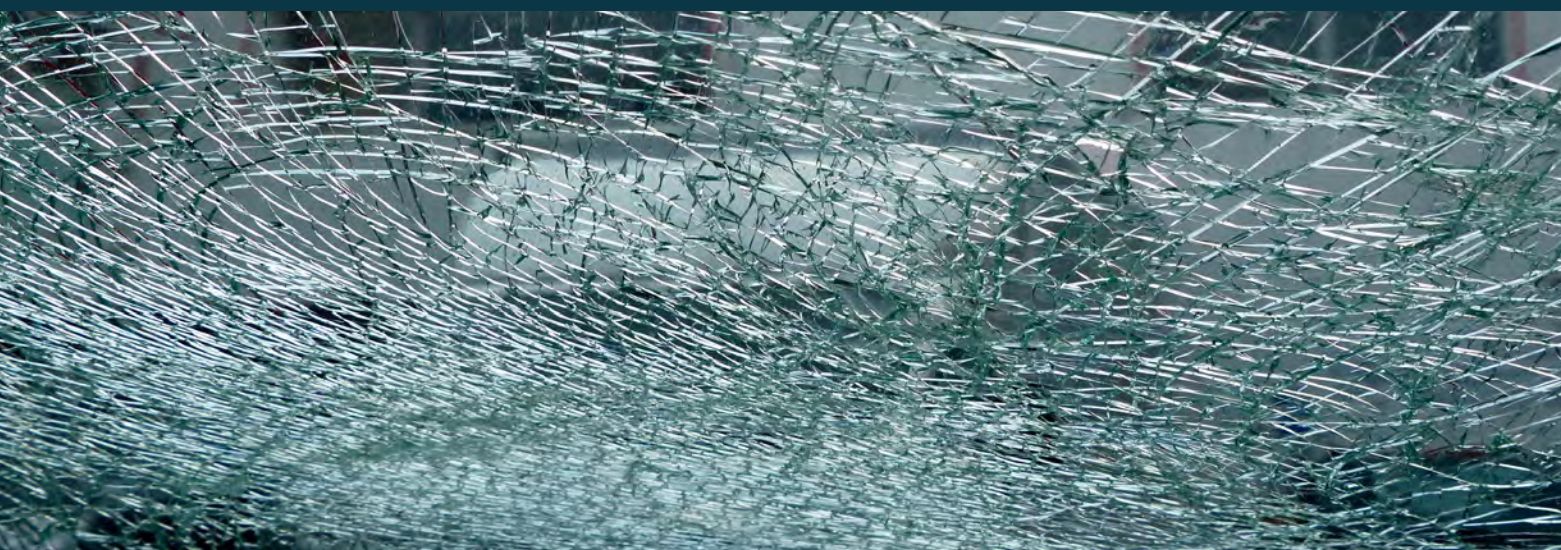
Splitterbild VSG (die Bruchstücke werden von mindestens einer Folie gehalten)
